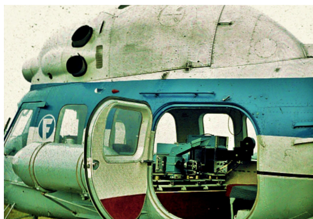
Ryc. 8. Helikopter przystosowany do wykonywania zdjęć w dalekiej podczerwieni.
