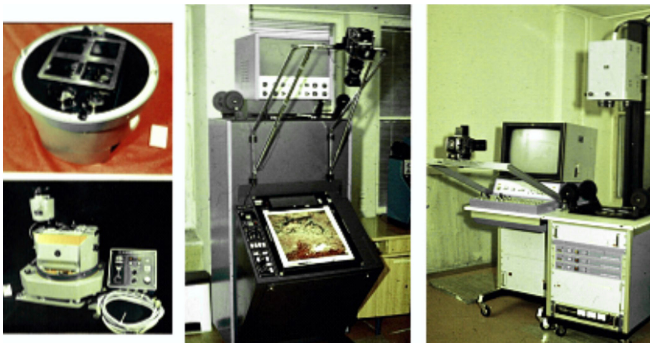
Ryc. 13. Lotnicza kamera wielospektralna firmy NAC oraz analogowa i elektroniczna przeglądarka addytywna do analizy zdjęć wielospektralnych.
