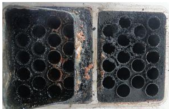
Rys. 7. Osady na wymienniku ciepła EGR – część wylotowa
