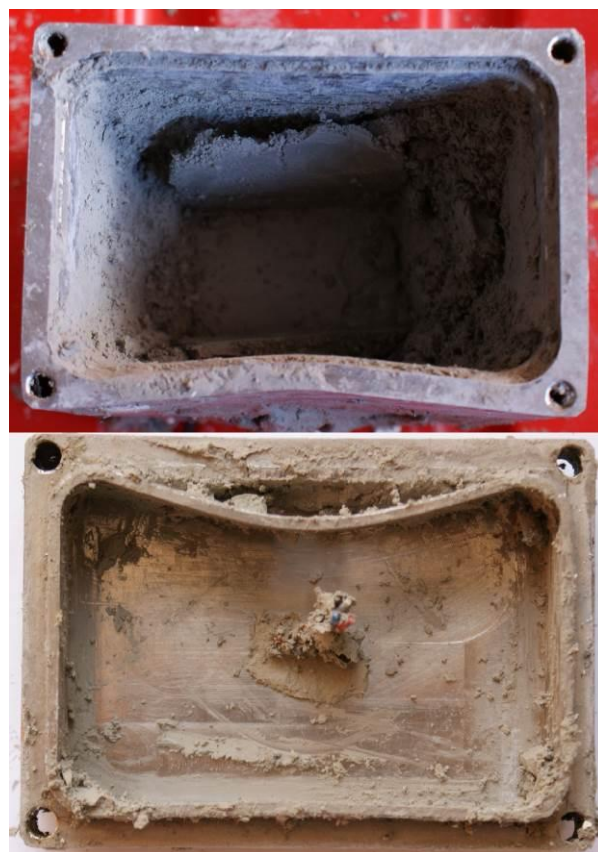
Fot. 2. Stan obudowy tytanowej po dokonaniu próby ciśnieniowej
