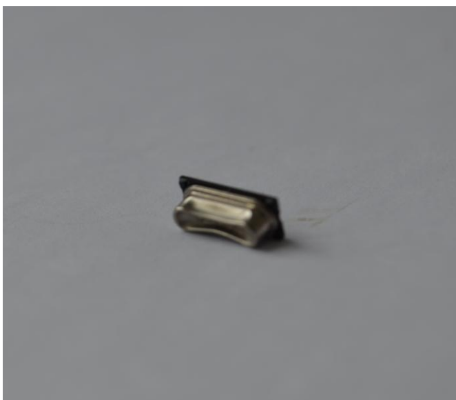
Fot. 4. Rezonator kwarcowy po dokonaniu próby ciśnieniowej
