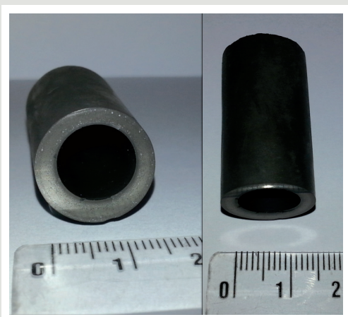
Rys. 4. Kompozyt \text{Al}_2\text{O}_3\text{-Ni} uzyskany metodą odlewania odśrodkowego mas lejnych.
