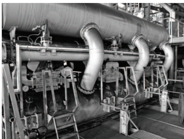
Rys. 1. Przykładowa osadzarka pulsacyjna dwukorytowa OM30 [5]
