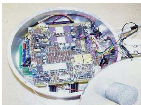
Rys. 9. Gniazdo wielodetektorowej czujki gazowej z układem PCB [8].
