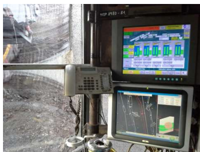
Fig. 10. The driver's cabin of the mining giant machine – on the right the screen with the "GPS cab" application Rys. 10. Kabina kierowcy wielkogabarytowej maszyny górniczej – po prawej stronie ekran z aplikacją „GPS cab”
