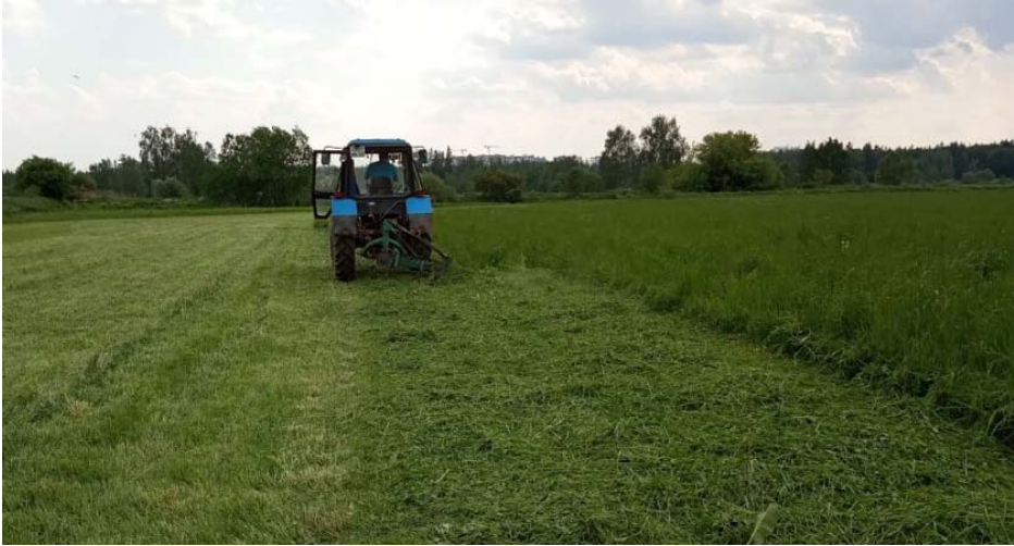
Фот. 1. Косилка КР-2,1М с экспериментальным кондиционером в агрегате с трактором Беларус 82.1 на кошении сеяных злаково-бобовых трав (фот. С.А. Отрошко)
