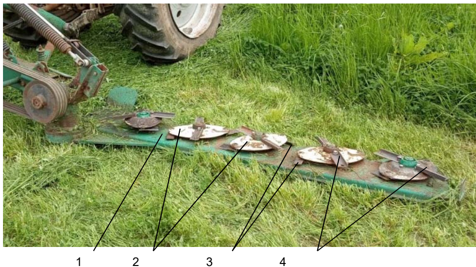
Рис. 1. Косилка КР-2,1М с ротационным кондиционером; 1 = несущий брус; 2 = диски; 3 = шарнирные ножи; 4 = шарнирные билы; источник: собственная обработка
