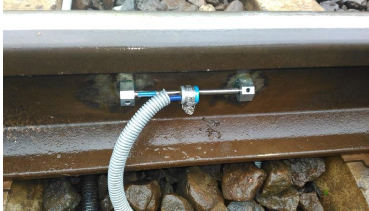
Rys. 1. Miernik naprężeń Geokon 400 z termistorem założony na jednej z linii kolejowych w Polsce [3]
