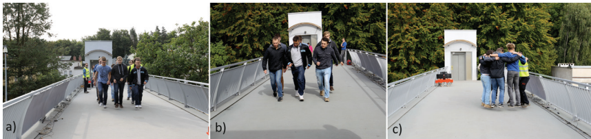
Rys. 7. Metody wzbudzenia dynamicznego kładek dla pieszych a) marsz b) bieg c) podskoki
