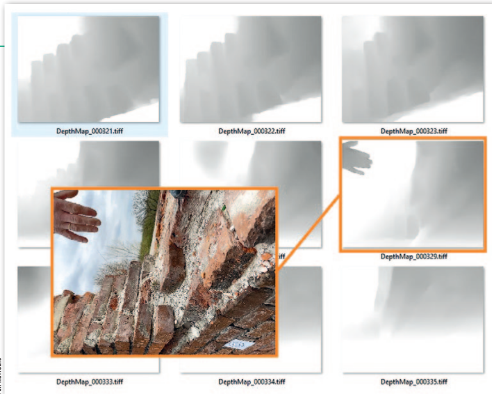
2. Przykład map głębi pomierzonych przez lidar w iPhone
