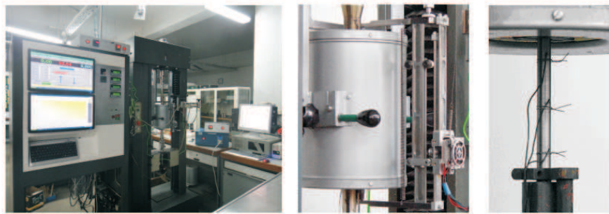
Rys. 2. Widok stanowiska do badań stali w podwyższonej temperaturze a). Widok pieca z układem tensometru b). Rozmieszczenie termopar na próbce c)
