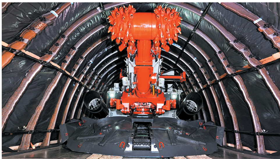
Rys. 5. Kombajn chodnikowy MR341/001 [2]
