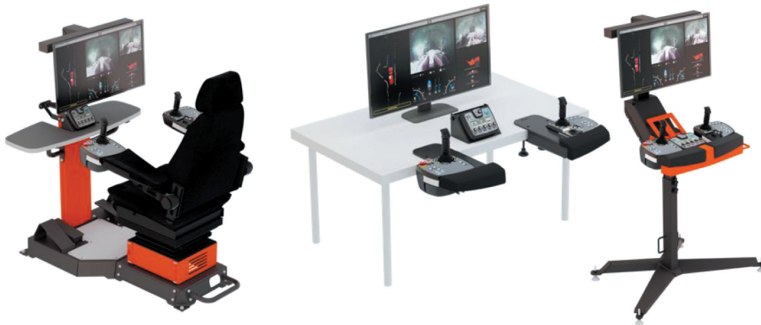
Rys. 16. Rodzaje stanowisk operatora [2]
