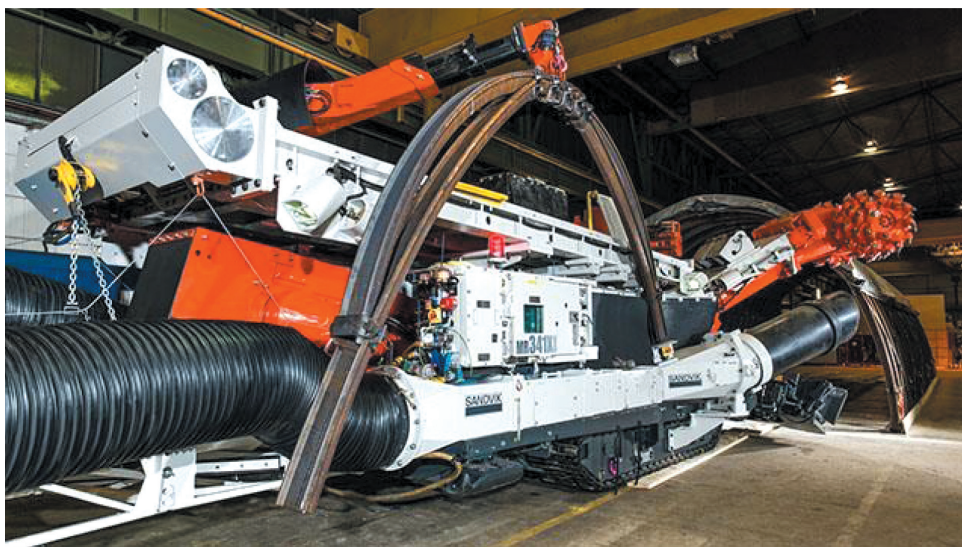
Rys. 7. Kombajn MR341/001 podczas transportu obudowy do zabudowy [2]
