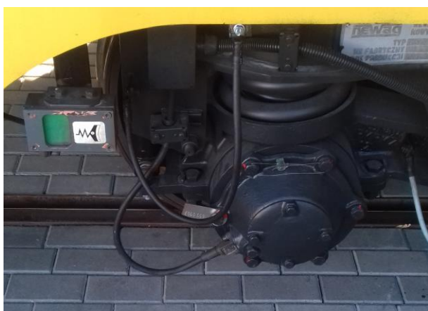
Rys. 5. Widok miejsca umocowania i sposobu prowadzenia przewodu czujnika prędkości w pojeździe typu 31WE. Opr. własne.
