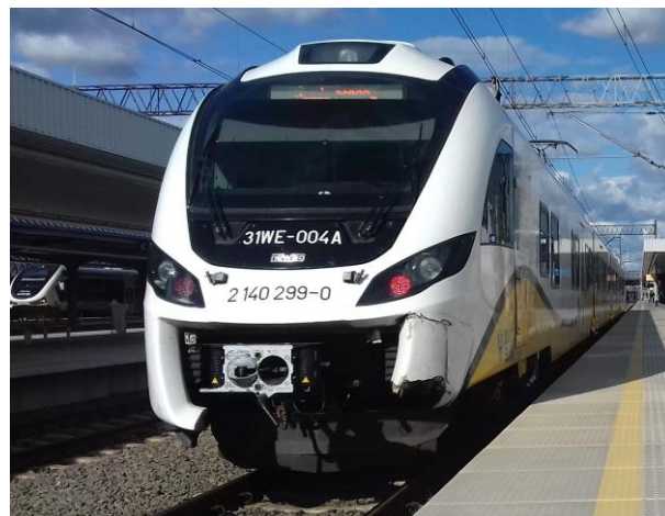
Rys. 6. Widok czoła pojazdu typu 31WE z uszkodzeniami laminatu poszycia kabiny w wyniku wielokrotnych kolizji ze zwierzyną. Opr. własne
