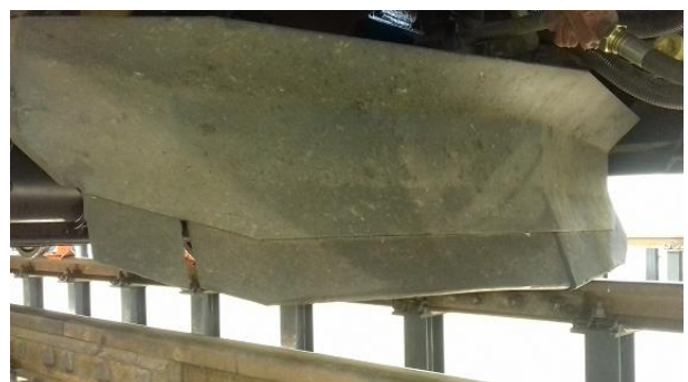
Rys. 4. Widok zgarniacza czołowego pojazdu typu 31WE. Opr. własne
