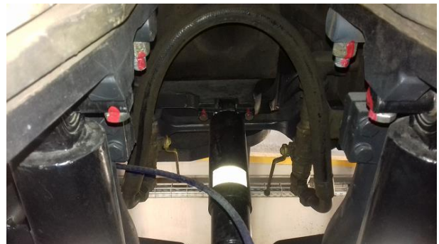
Rys. 3. Widok złącza pneumatycznego międzyczłonowego pojazdu typu 31WE. Opr. własne.
