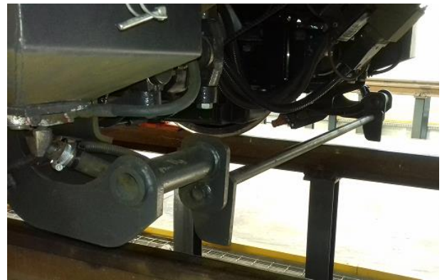
Rys. 2. Widok zgarniaczy szynowych pojazdu typu 31WE wraz z łącznikiem między nimi. Opr. własne.
