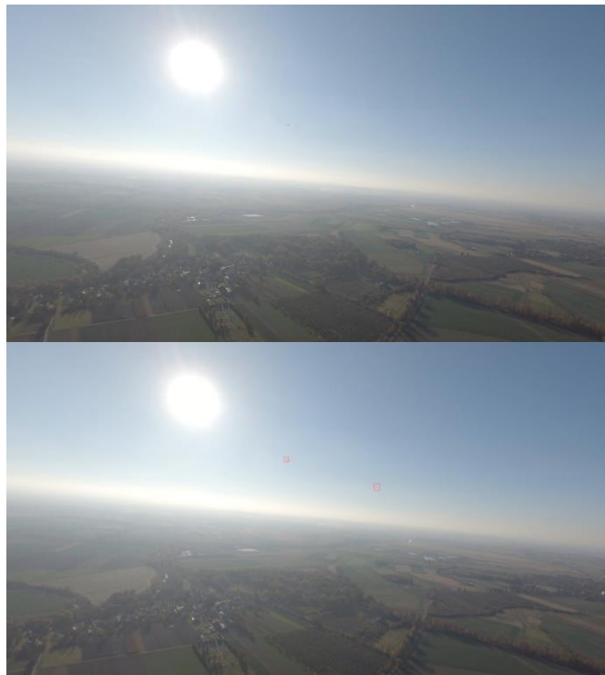
Rys. 11. Przykład detekcji dwóch intruzów w trakcie realizacji scenariusza z rys. 9: obraz wyjściowy z kamery (u góry) i przetworzony obraz wyjściowy z systemu wizyjnego (u dołu).
