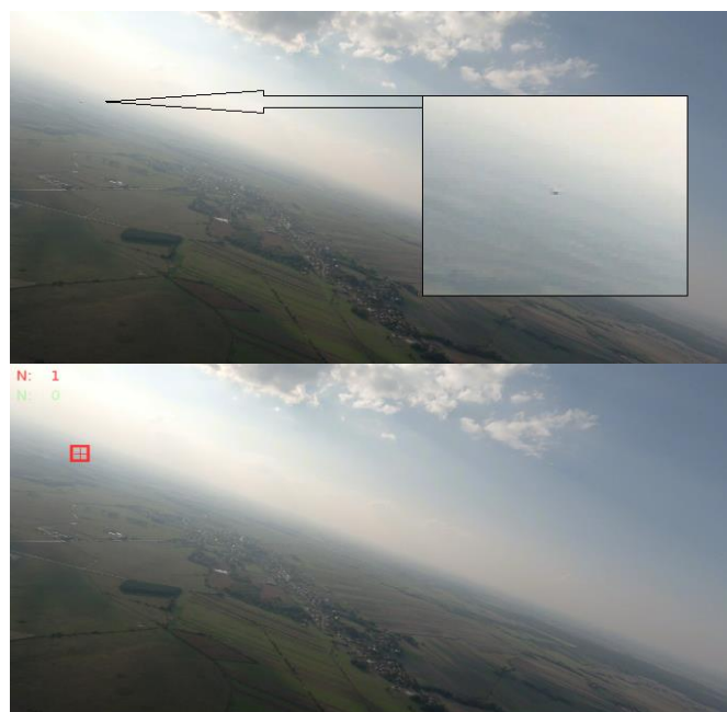
Rys. 3. Obraz wyjściowy z kamery z powiększonym widokiem intruza (u góry) i przetworzony obraz wyjściowy z systemu wizyjnego z wykrytym intruzem (u dołu)
