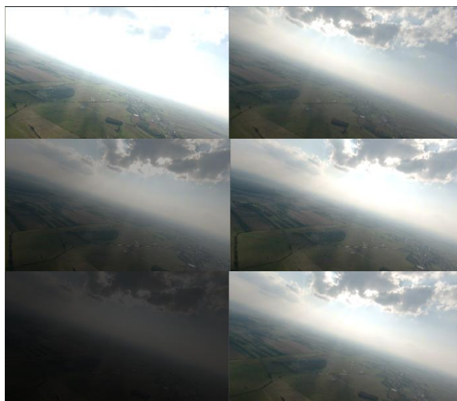
Rys. 2. Rezultat działania modułu adaptacyjnego: po lewej stronie obraz zakłócony, po prawej stronie obraz przetworzony
