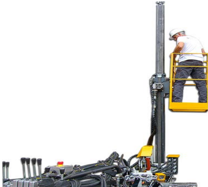
Rys. 14. Samobieźna kotwiarka ANDRIBOT – pomost roboczy (Geofinal)
