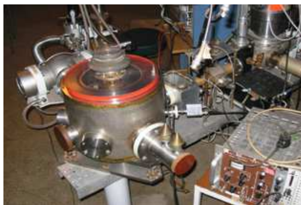
Fot. 8. Stanowisko pomiarowe używane do pomiarów z zastosowaniem metody RBS
