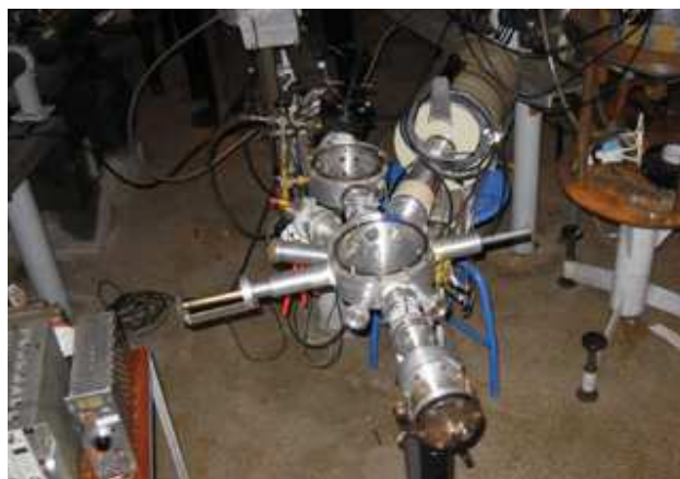
Fot. 9. Stanowisko pomiarowe do zastosowań metody PIXE
