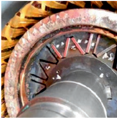
Rys. 3. Widok wirnika z magnesami trwałymi silnika o mocy P=110 kW Fig. 3. A picture of the fabricated rotor of 110 kW LSPMSM
