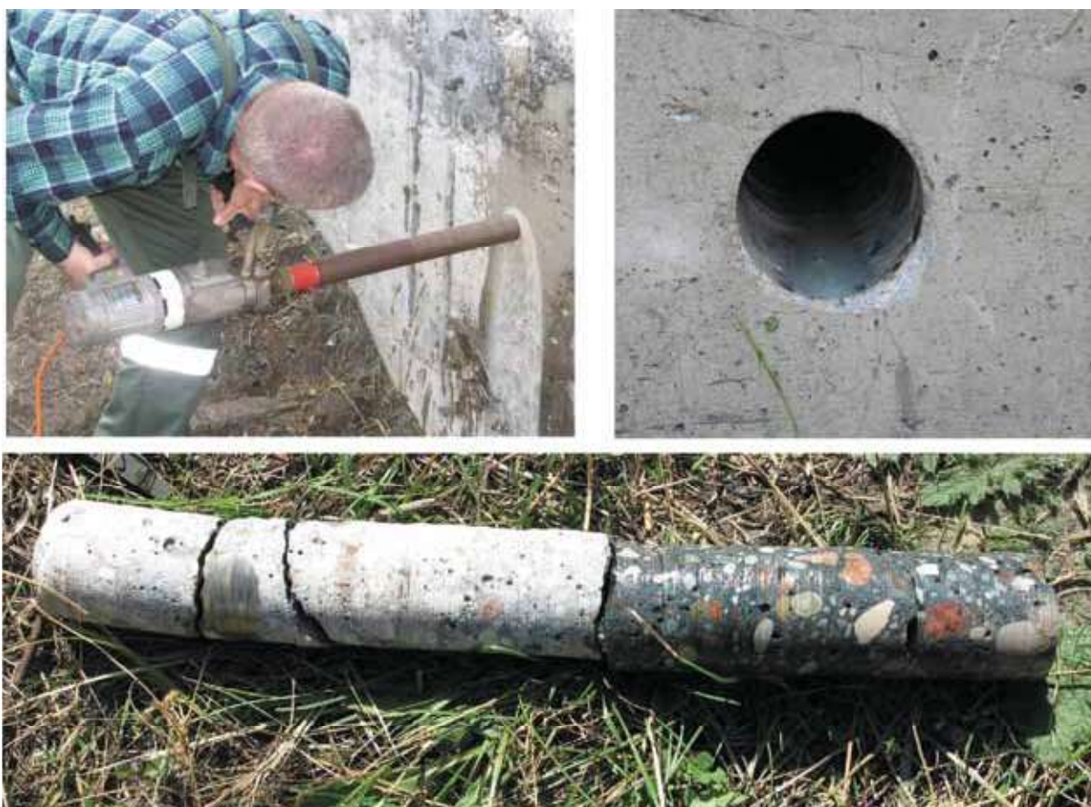
Rys. 3. Sposób pobierania rdzenia, otwór oraz pobrany rdzeń Fig. 3. Method of taking the core; the hole and obtained core
