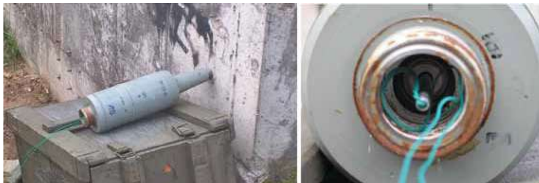
Rys. 4. Głowica bojowa 125 mm kumulacyjnego pocisku czołgowego BK-14 wraz z wmontowanym detona- torem oraz zapalnikiem elektrycznym gotowa do odpalenia
