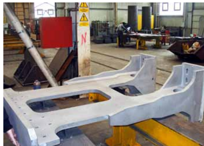
Ryc. 13. Element kotwiący przygotowany do zabetonowania w poprzecznicy
