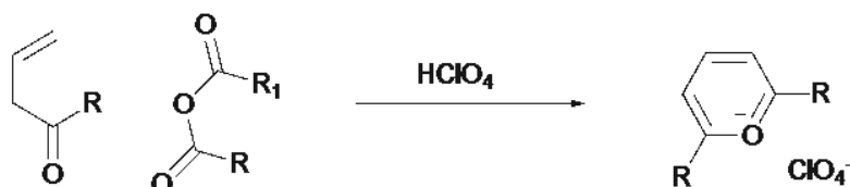
Rysunek 18. Otrzymywanie nadchloranów piryliowych z \alpha,\gamma -nienasyconych ketonów, R – alkil Figure 18. Preparation of pyrylium perchlorates from \alpha,\gamma -unsaturated ketones, R – alkil
