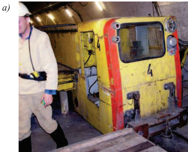
Rys. 1. Górnicze lokomotywy akumulatorowe produkcji polskiej [2] a) Lea BM-12, b) Ldag 05M
