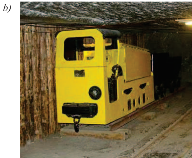
Rys. 1. Górnicze lokomotywy akumulatorowe produkcji polskiej [2] a) Lea BM-12, b) Ldag 05M
