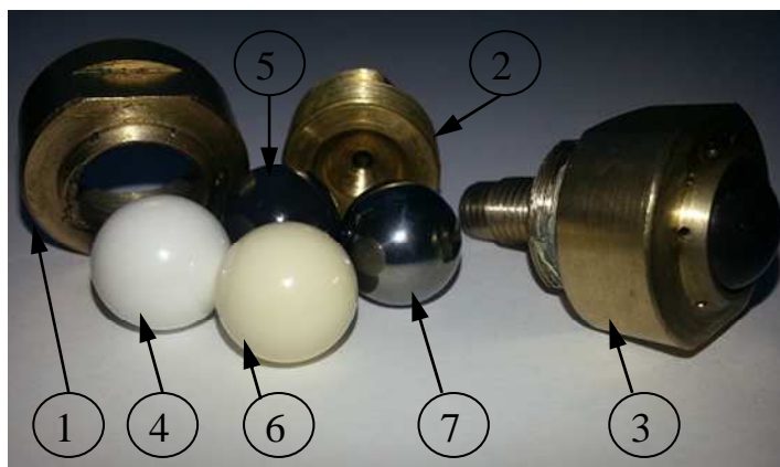
Rys. 2. Oprawka kulek ceramicznych ½" z łożyskowaniem hydrostatycznym: 1 - nakrętka, 2 - gniazdo, 3 - oprawka - komplet (nakrętka, gniazdo i kulka), 4 - kulka ZrO 2 , 5 - kulka Al 2 O 3 , 6 - kulka Si 3 N 4 , 7 - kulka WC Fig. 2. The ceramic ball holder of ½ " equipped with the hydrostatic bearing: 1 - a nut, 2 - a seating, 3 - a holder – the set of elements (a nut, a seating and a ball), 4 - a ball made of ZrO 2 , 5 - a ball made of Al 2 O 3 , 6 - a ball made of Si 3 N 4 , 7 - a WC ball
