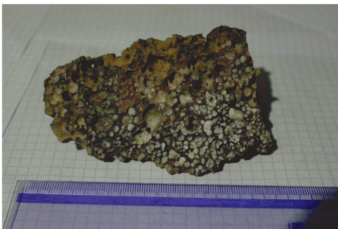
Rys. 2. Paleobazalt z Regulice z dużą zawartością pęcherzy pogazowych wypełnionych minerałami wtórnymi
