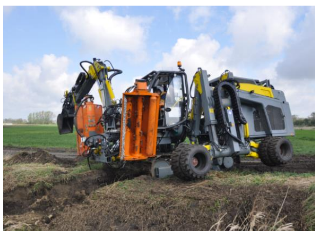
Fig. 16. Entering the device into a ditch after escarpment grading Rys. 16. Wjazd urządzenia do rowu po rozkopanej skarpie
