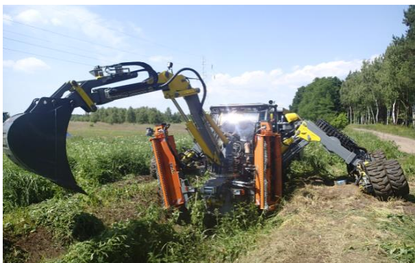
Fig. 9. The sticking out a side arm in the escarpment Rys. 9. Wystawienie ramienia bocznego na skarpę
