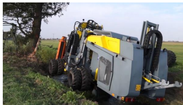
Fig. 19. The tilting of the machine while passing by the trees on a escarpment Rys. 19. Przechylenie maszyny podczas omijania drzew rosnących na skarpie
