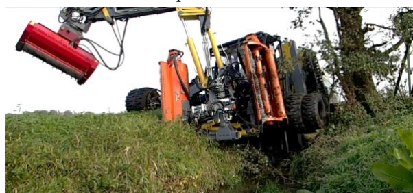
Fig. 20. The deflection of the boom during passing by plants growing on a slope Rys. 20. Odchylenie wysięgnika podczas omijania roślinności rosnącej na skarpie
