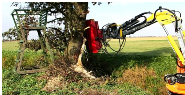
Fig. 18. The grubbing-up of the branch in the area of ditches Rys. 18. Karczowanie gałęzi znajdujących się w przestrzeni rowów
