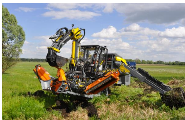
Fig. 13. Entering to small ditches without escarpment grading Rys. 13. Wjeżdżanie do małych rowów bez rozkopywania skarp
