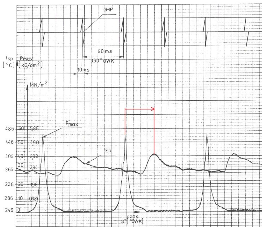
Rys. 7. Przebiegi zmian temperatury spalin wylotowych, ciśnienia w cylindrze oraz położenia GMP tłoka jako funkcji kąta obrotu wału korbowego jednocylindrowego, czterosuwowego silnika o ZS, w stanie odniesieniowym - pełnej zdadności technicznej [Rutkowski 1976]
