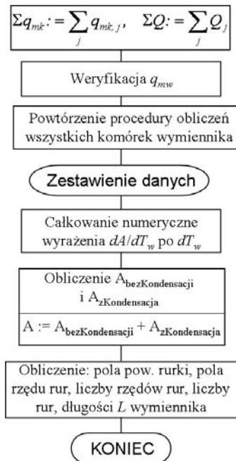
Rys. 5. Schemat blokowy procedury obliczeń końcowych wymiennika ciepła
