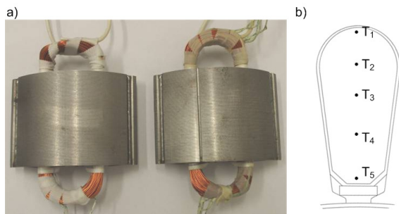
Rys. 1. Skonstruowane cewki na potrzeby doświadczenia (a) oraz rozmieszczenie termopar w cewce (b)
