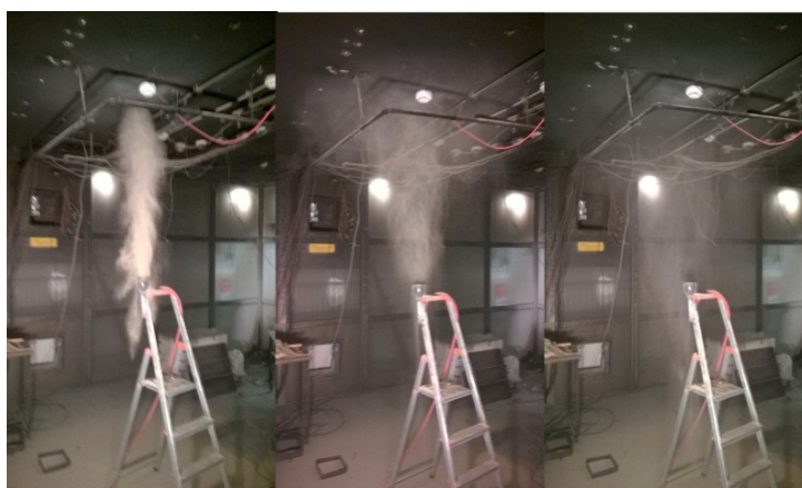
Ryc. 4. Badanie z użyciem pyłu sosny 500 µm Fig. 4. Test using pine wood dust of 500 µm Źródło: Opracowanie własne. Source: Own elaboration.
