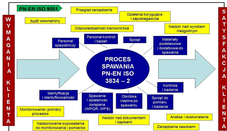
Rys. 1. Ogólny schemat wpływu wymagań normy PN-EN ISO 9001 i PN-EN ISO 3834-2 przy realizacji konstrukcji spawanej, w przypadku której głównym procesem jest proces spawania Fig. 1. The general scheme of the impact of PN-EN ISO 9001 and BS EN ISO 3834-2 in the implementation of the weldment, where the main process is the welding process Źródło: [2].
