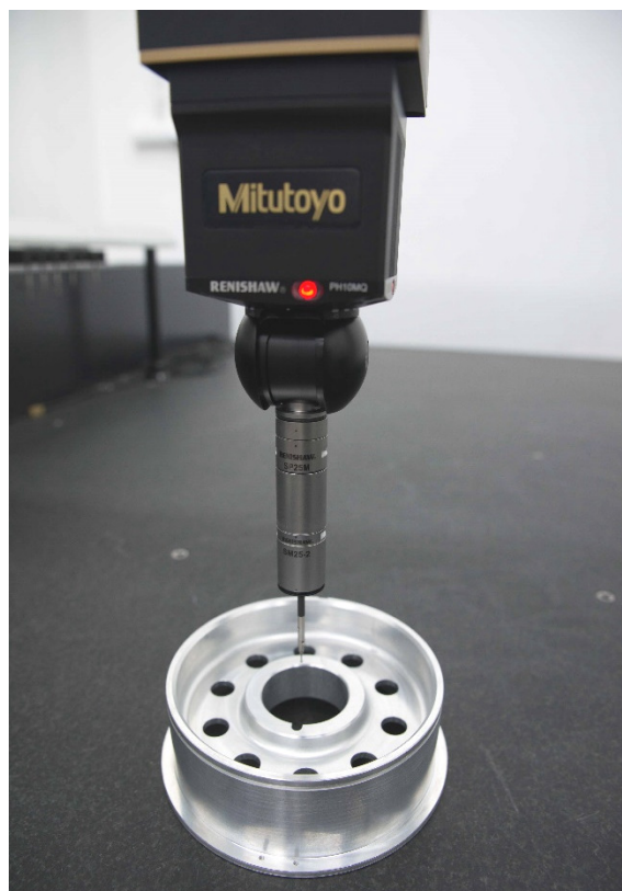
Rys. 13. Piasta silnika – pomiar współrzędnościową maszyną pomiarową
