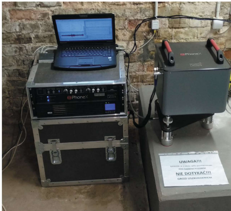
Rys. 2. Stanowisko grawimetryczne w piwnicy Industrialnego Centrum Kultury Kopalni „Ignacy” w Rybniku - Niewiadomiu. Grawimetr z platformą samopoziomującą na postumencie betonowym (prawa strona) i blok sterowania (lewa strona)
