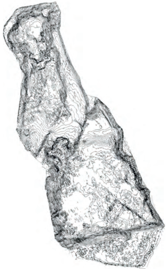
Rys. 7. Izolinie dna i zboczy zbiornika Lubstów uzyskane na podstawie pomiarów batymetrycznych [6] Fig. 7. Isolines of the bottom and slopes of Lubstów reservoir obtained from bathymetric measurements [6]
