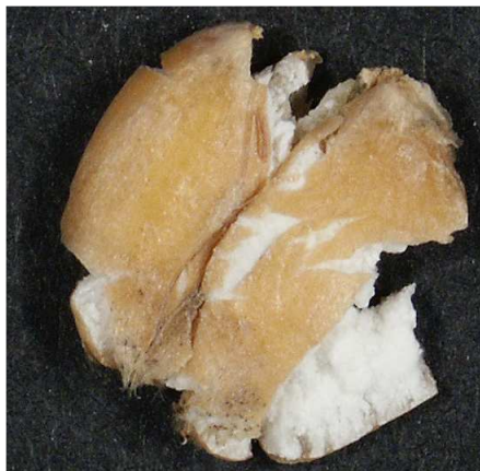
Rys. 4. Ziarno pszenicy o wilgotności 16,0 % po zgnieceniu Fig. 4. Wheat grain of 16,0 % humidity after crushing
