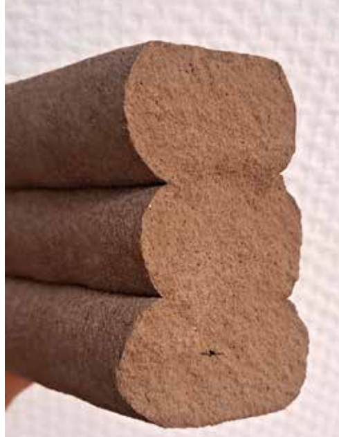
Fot. 4. Przekrój poprzeczny poszczególnych warstw – fragment ściany
