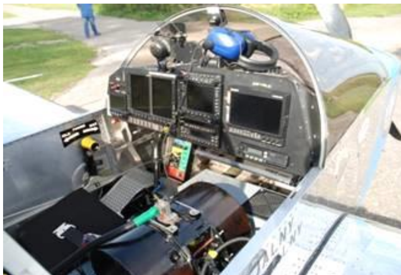
Rys. 3. Widok aparatury oblotowej zamontowanej w kabinie samolotu SONEX LL (Podciechowski i in., 2016)
