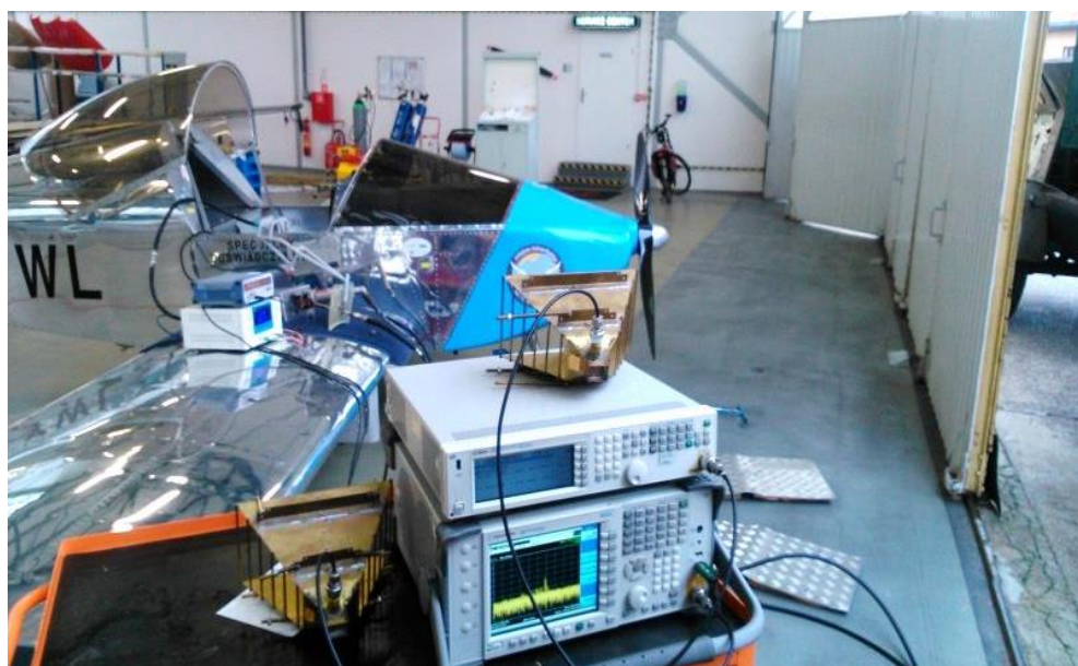
Rys. 4. Widok stanowiska do autonomicznych sprawdzeń aparatury oblotowej
