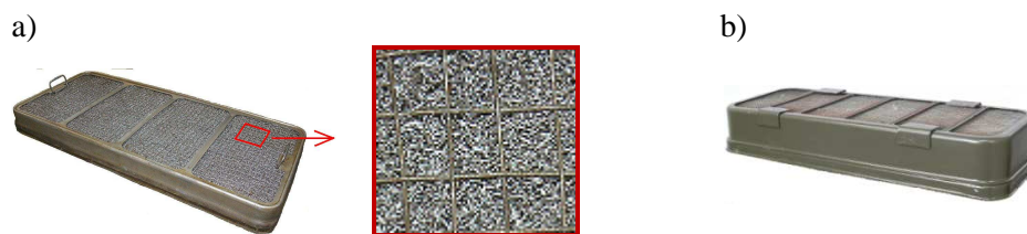
Rys. 4. Kasety filtracyjne: a) filtru powietrza czołgu T-72 (złożę z drutu stalowego), b) samochodu ciężarowo-terenowego Star 266 (złożę z włókien sztucznych)
