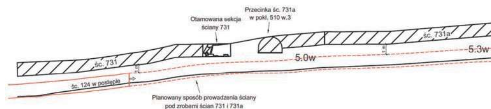
Rys. 2. Planowany sposób prowadzenia ściany 124 pod zrobami zawałowymi ścian 731 i 731a z pozostawieniem półki węglowej o grubości około 1,0 m
