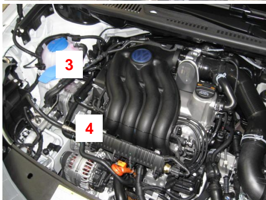
Rys. 1. Rozmieszczenie zbiorników gazu i instalacji w komorze silnikowej: 1 – zbiorniki CNG, 2 – zbiornik Pb98, 3 – reduktor ciśnienia gazu, 4 – zasobnik ciśnienia i wtryskiwacze gazu
