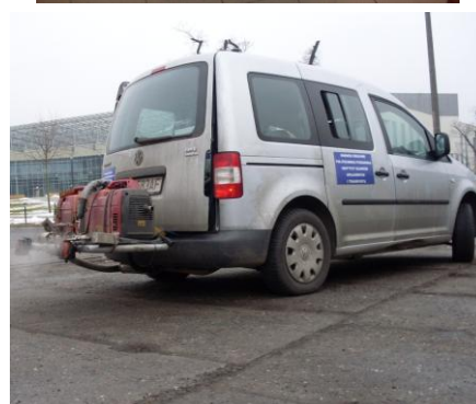
Rys. 5. Pojazdy z zainstalowaną aparaturą do pomiaru emisji spalin w rzeczywistych warunkach ruchu
