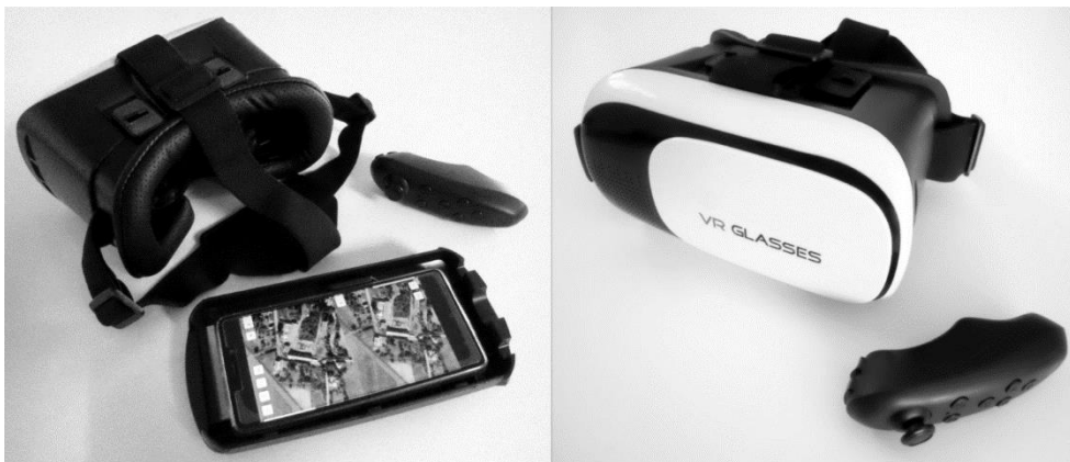
Rys. 2. Sprzęt wykorzystany do wizualizacji stereoskopowej zdjęć lotniczych – okulary VR ze smartfonem oraz pilot bezprzewodowy.
