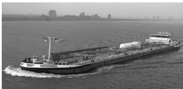
Rysunek 2. MT Argonon – pierwszy śródlądowy statek zasilany LNG
