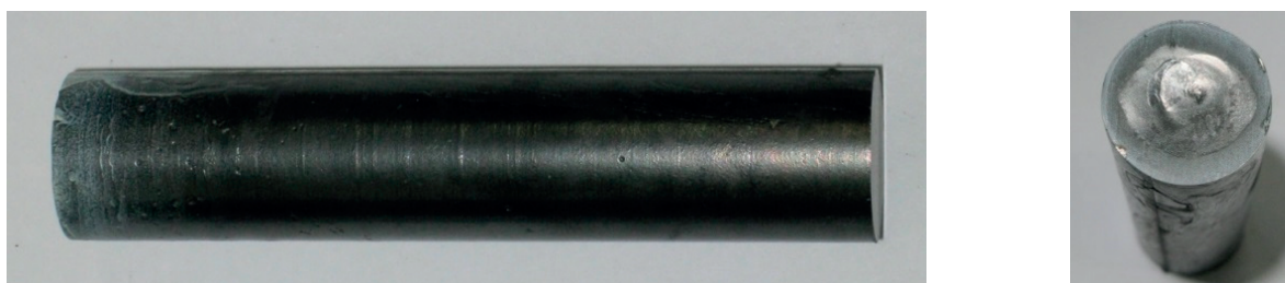
Rys. 3. Odlew wykonany ze stopu cyrkonu 702
