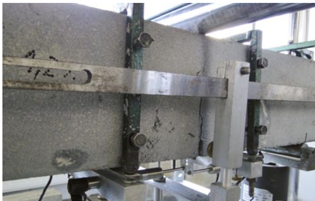
Rys. 11. Przykładowy obraz zniszczenia belki z włóknami stalowymi
