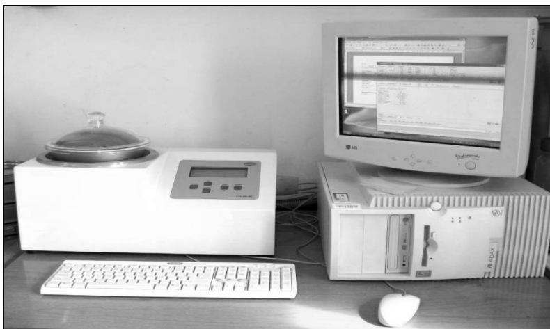
Rysunek 2. Laboratoryjny separator pneumatyczny LPS 200 MC Figure 2. Laboratory pneumatic separator LPS 200 MC
