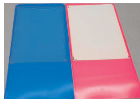
Rys. 12. Zmiana wyglądu powłoki po ekspozycji w komorze starzeniowej na działanie promieniowania UV
