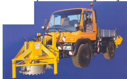
Rys. 4. Głowica do wycinania otworów w gruncie (jezdni) zamontowane na samochodzie.
