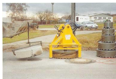
Rys. 3. Głowice do wycinania otworów w gruncie (jezdni)
