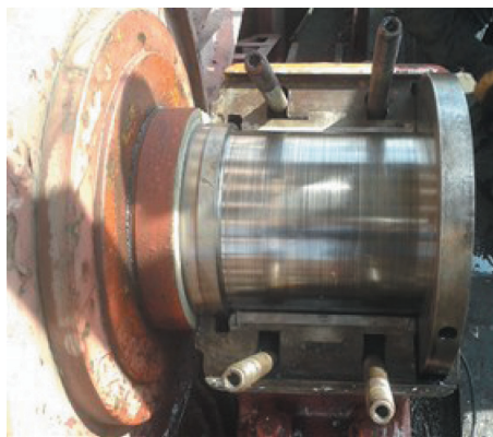
Rys. 8. Rysy obwodowe na powierzchni czopa łożyskowego osi
