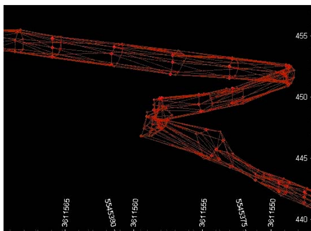
Rys. 4. Fragment modelu sieciowego sztolni Św. Leopolda Fig. 4. Fragment of wireframe model of St. Leopold shaft
