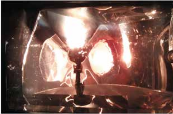
Fot. 5. Przykład konstrukcji reflektora samochodowego w technologii FF z żarówką jednowłóknową. „Płynna” struktura odbłyśnika
