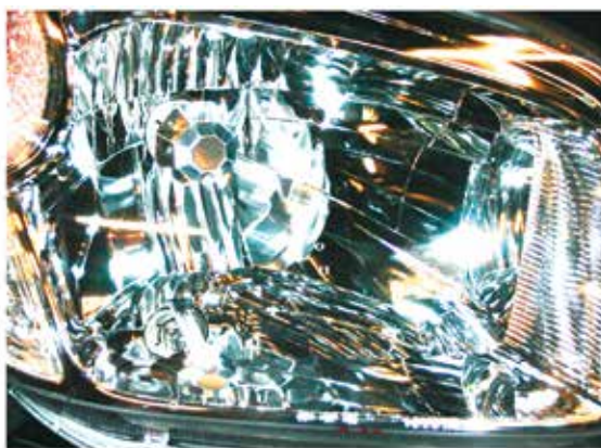
Fot. 4. Przykład konstrukcji reflektora samochodowego w technologii FF z żarówką dwuwłóknową H4. „Fasetowa” struktura odbłyśnika
