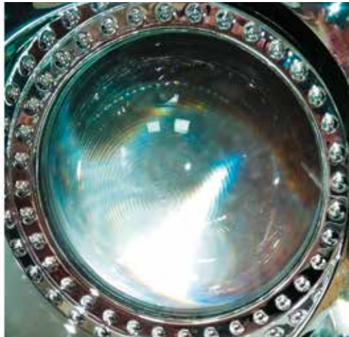
Fot. 3. Przykład reflektora elipsoidalnego
