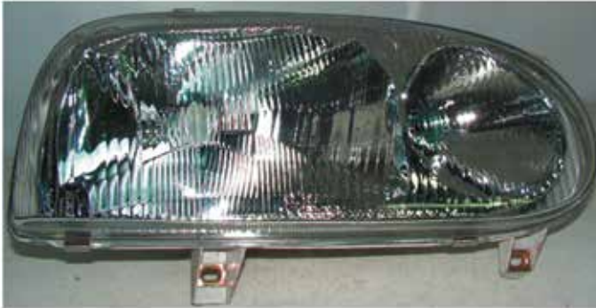
Fot. 2. Reflektor „dwuparaboloidalny”
