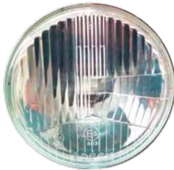
Fot.1. Przykład paraboloidalnej konstrukcji reflektora samochodowego
