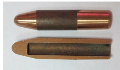
Rys. 2. Elektroda do punktowego zgrzewania oporowego Fig. 2. Point resistance welding electrode
