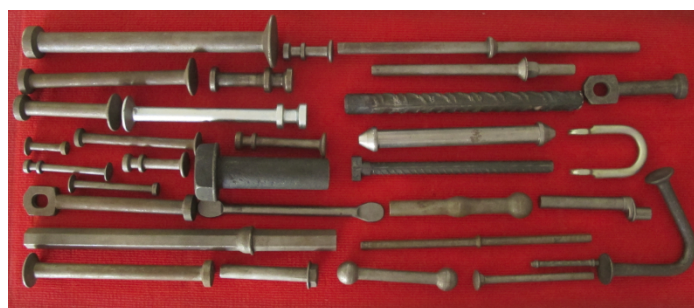
Rys. 6. Odkuwki wykonane w specjalnych przyrządach do kucia
