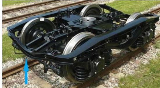
Rys. 13. Wózek kolejowy towarowy typu Y25. Strzałką zaznaczono belkę czołową
